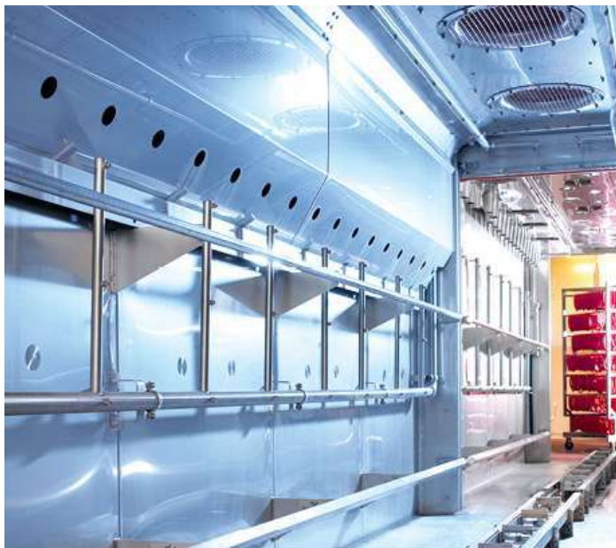
Răcire cu aer rece și dusare cu apă fierbinte și rece
