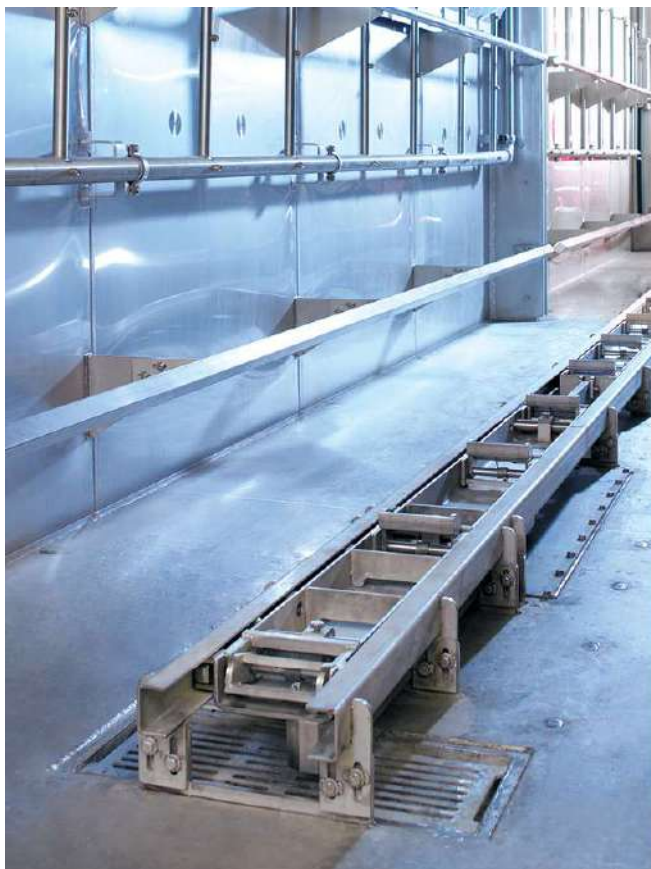
Conveier balansier(tip suveică) pentru rame cu rulare pe pardoseală
