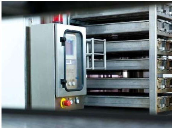
Construcție specială pentru forme cu adâncimea de 1500 mm și sarcini mari
