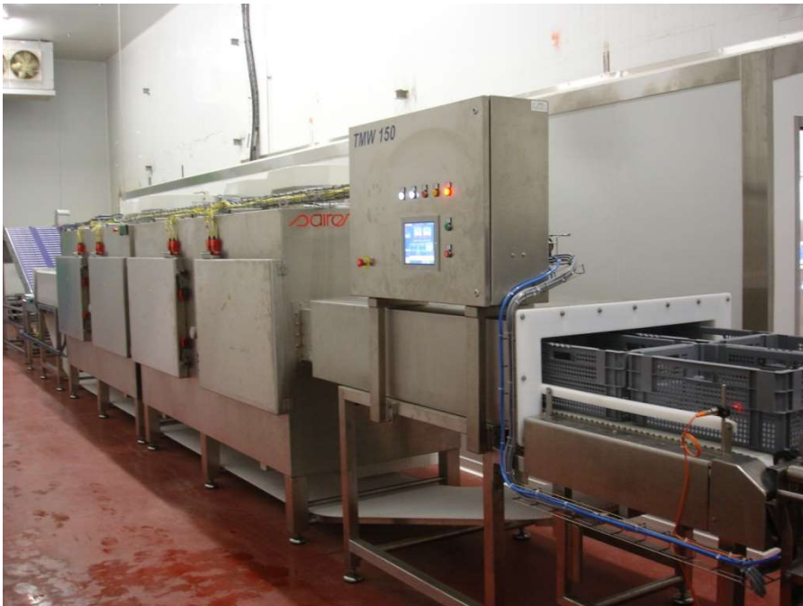
TMW 150(5.000 - 6.000 kg/h) generator de microunde de 150 kW
