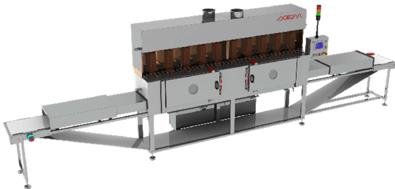
Tunel de uscare cu microunde pentru laboratoare/stații pilot 12 kW; 2,45 GHz
