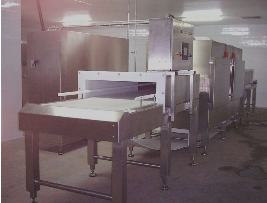
TMW 75 ( 2.500 - 3.000 kg/h) generator de microunde de 75 kW
